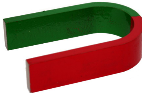
Figura 8.3.: Ímã de forma de ferradura. O pólo norte está pintado de vermelho, e o pólo sul de verde.
