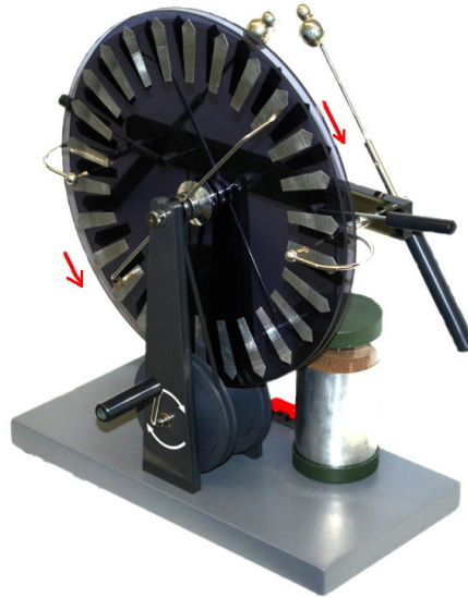
Figura 1.9.: Máquina de Wimshurst.
